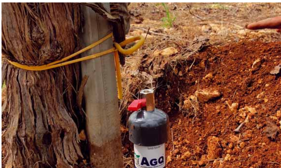
Foto 6 Sonda per il prelievo della soluzione circolante
